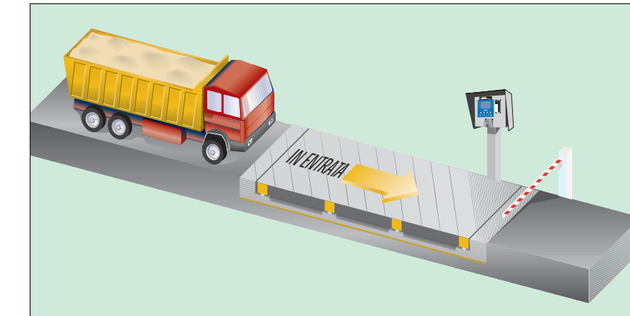
Pesatura senza operatore. L'automezzo transita e si posiziona sulla pesa, sempre nello stesso senso di marcia.
